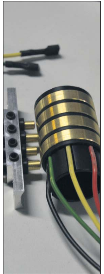
De bedrading van de schakelaars op het stuur kan niet meer door het binnenste van de stuuras. Dit is de oplossing van EZ Power Steering.
