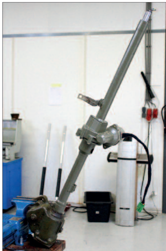
Oog voor detail, nieuw stuurhuis met bekrachtiging voor een Dodge Weapon Carrier oorlogsveteraan
