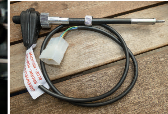
Ein Sensor in der Tachowelle anstelle des Drehreglers informiert das Steuergerät über die Geschwindigkeit und regelt die Unterstützung
