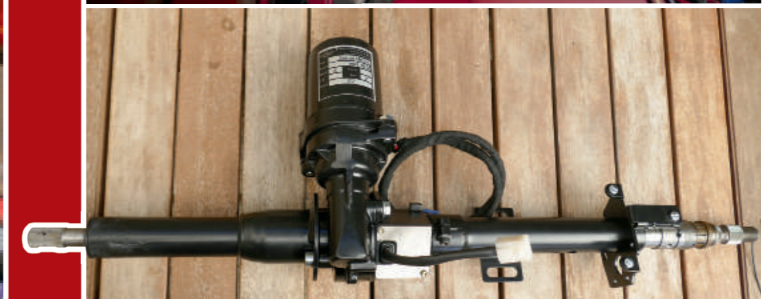
Das ist alles: Die neue Lenksäule kommt mit sämtlichen elektromechanischen Bauteilen und lässt sich anstelle der originalen Säule montieren
