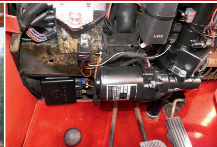
Neben dem Lenkmotor sitzt das Steuergerät. Später versteckt sich alles unter der serienmäßigen Abdeckung
