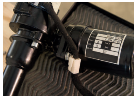
Das ist neu: der 12-Volt-Motor an der neu lackierten Lenksäule und das kleine Steuergerät
