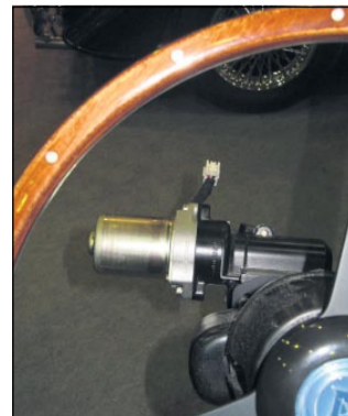
Servomotoren kommer til at sidde godt gemt et stykke nede på ratstammen.
