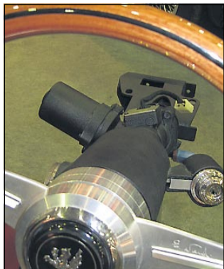
Sættet består af en anden ratstamme med servomotoren monteret på siden af ratstammen.
